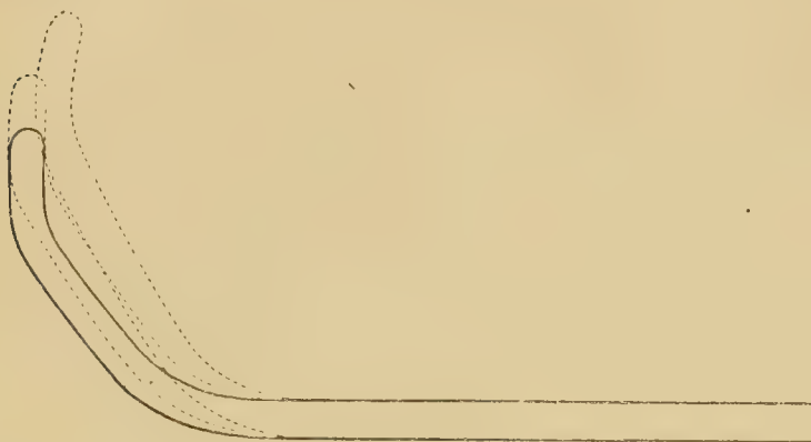
FIG. 5. — Positions successives de la sonde quand on associe le mouvement de propulsion de la sonde au retrait du mandrin.
